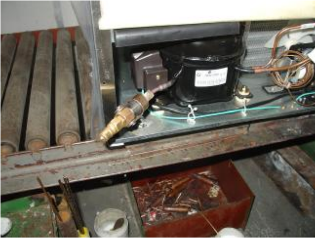
f. 系统充氮，在快装接头处接入 0.8Mpa 氮气
