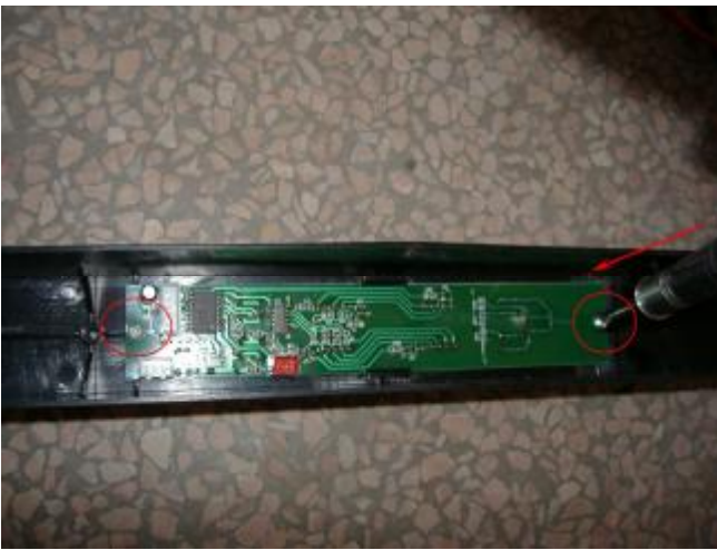
f. 插好接线柱 Plug the terminal.
